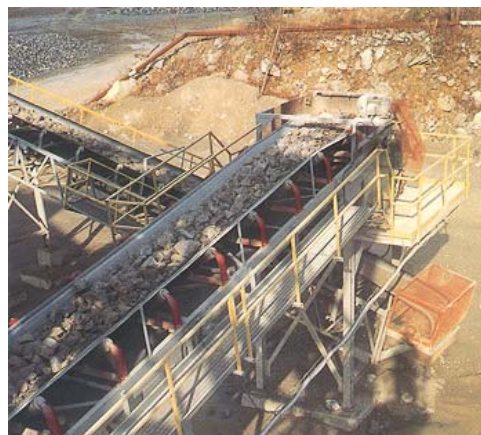
Przenośniki wymagają zastosowania przemiennika częstotliwości do zapewnienia wysokiego momentu obrotowego i regulacji prędkości obrotowej w zakresie od kilku obr/min do prędkości maksymalnej.
