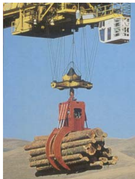
W urządzeniach dźwigowych silnik powinien dysponować bardzo wysokim momentem rozruchowym nawet przy zerowej prędkości. Celowe jest tu zatem zastosowanie napędu wektorowego.
